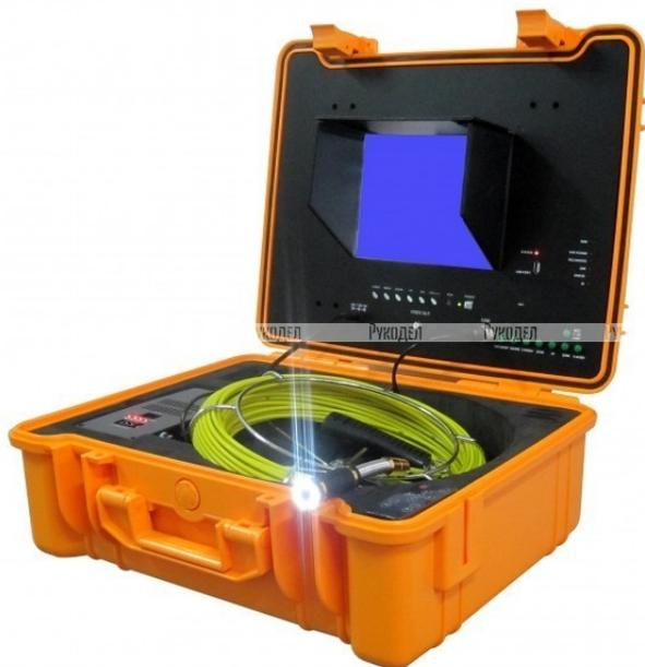
Система видеодиагностики CROCODILE позволяет произвести обследование участков труб, вентиляционных шахт, скважин диаметром от 75 до 400 мм для выявления актуального технического состояния. Система позволяет произвести запись обследования труб, а так же добавлять запись звука в момент обследования. Цветная камера с сапфировым стеклом и светодиодами, позволяет получить четкое изображение на мониторе.
