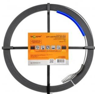
Пробивная лента для удаления засоров КРОКОЧИСТ предназначена для разрушения и проталкивания засора в трубе. Пробивная лента оснащена специальной насадкой, которая дает возможность проходить 1-2 поворота по 45 градусов в трубе диаметром 76-110мм.
